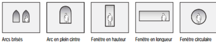
Variations géométriques sur la fenêtre.
